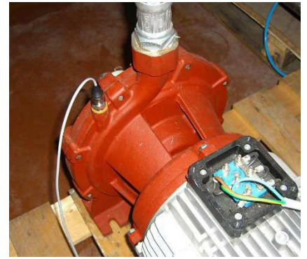
Rys. 5: przykładowy otwór zasysania pompy z zamontowanym przetwornikiem
